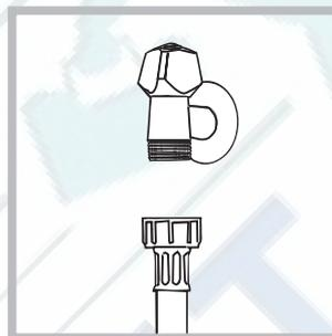
1. Прикрутите шланг подачи к крану холодной воды с резьбовым отверстием 3/4 газ (см. схему).
